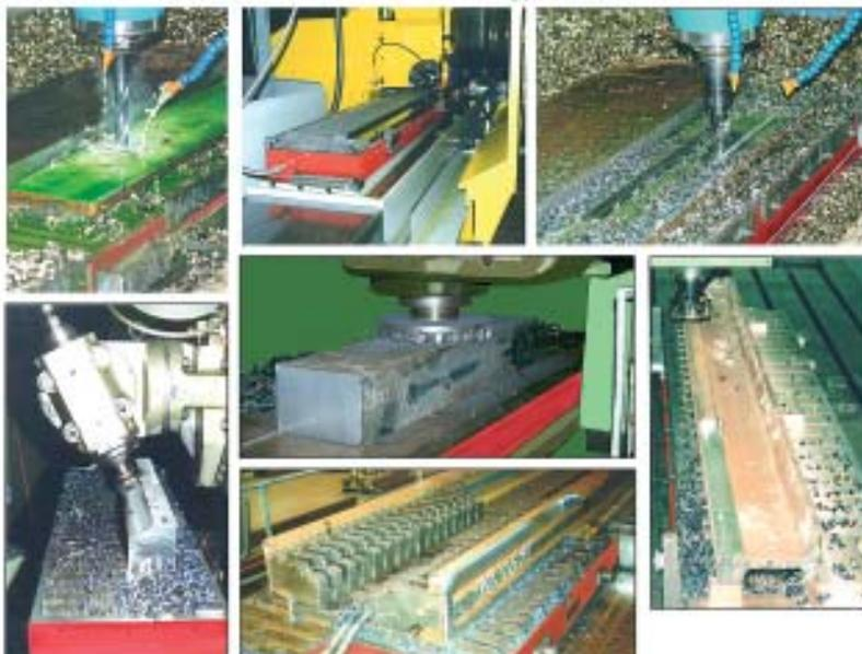
As placas eletropermanentes reduzem o tempo de *set-up* drasticamente!
